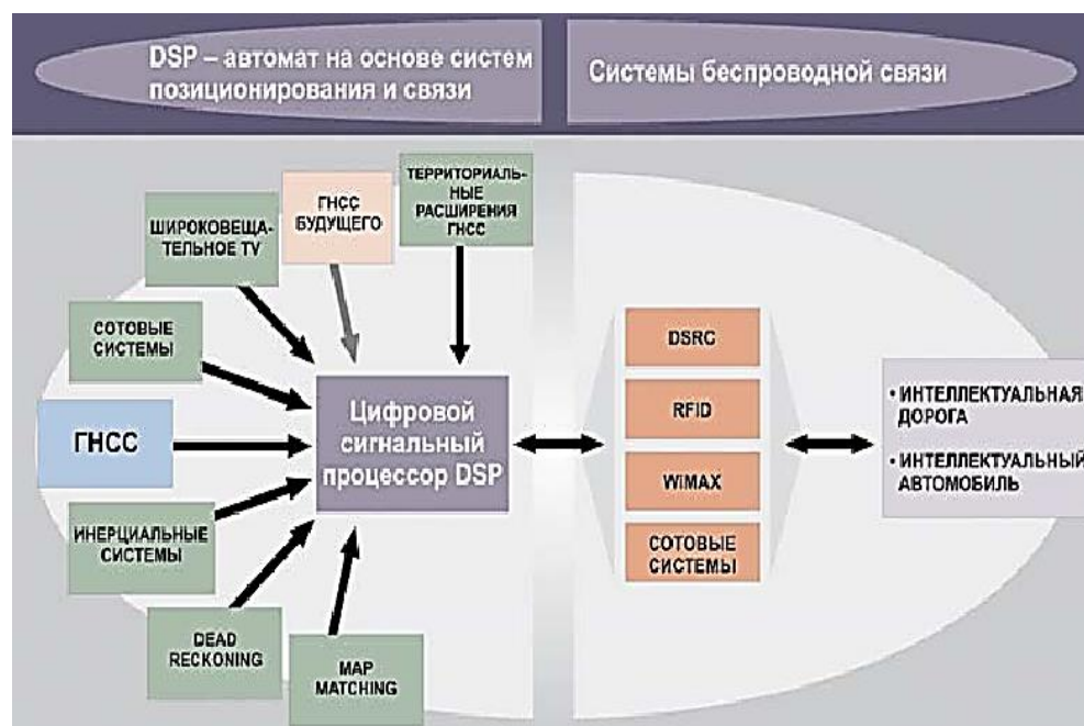
Рисунок 9. Технологии, используемые для построения навигационных приложений ИТС
